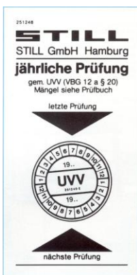
Pav. 12. Tikrinimų plakatas palengvina vairuotojui stebėti tikrinimo terminus
