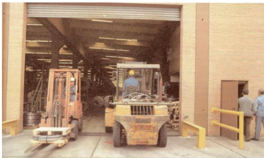
Pav. 16. Transporto priemonių ir asmenų judėjimo kelių atskyrimas. Saugus atstumas tarp šakinių krautuvų min 0,4 m, iki vartų ribų – min 0,5 m.
