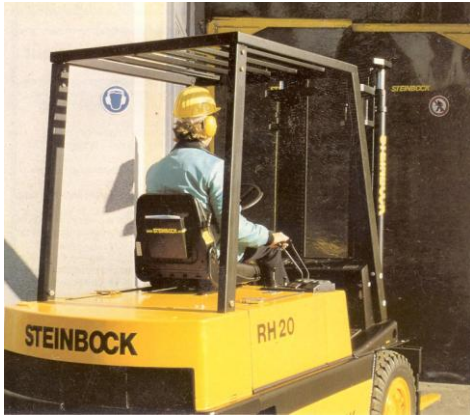
Pav.9. Ergonomiškai įrengta vairuotojo sėdynė. Vairuotojas triukšmingoje zonoje naudoja klausos apsaugos priemones – ausines
