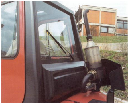
Pav. 7. Šakinis krautuvai su suodžių filtru (filto pajėgumas – apie 8 val.)
