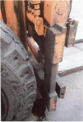
Pav. 11. Nesandari hidraulinė sistema ir svetimkūnis padangoje
