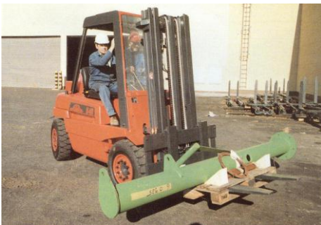
Pav. 40. Šakinis krautuvas su keleivio sėdyne ir tvirtu lanku laikymuisi.
