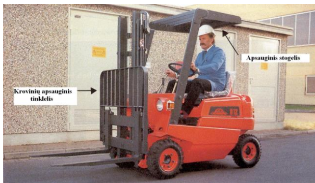
Pav.5. Vairuotojo apsauginis stogelis ir krovinų apsauginis tinklėlis.
