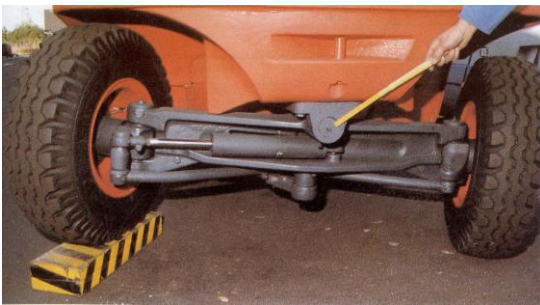
Pav. 33. Kuomet keturių ratų šakiniam krautuve užpakalinė ašis yra valdoma, vienintelė vidurinė krovinio atrama yra kaip tik tos ašies guolyje
