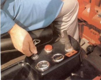
Pav.37. Šakinį krautuvą galima palikti tik tada, kai išjungta pavara ir ištrauktas raktelis.
