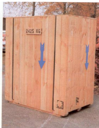
Pav. 24 ir 25. Šios smulkinimo mašinos svorio centras yra ne centre. Paprastas, tačiau aiškus ženklavimas nurodo šakinio krautuvo vairuotojui, kur turi įvažiuoti šakių peiliai, koks krovinio svoris ir kur yra jo svorio centras, būtent, strėlės (rodyklės) gale.
