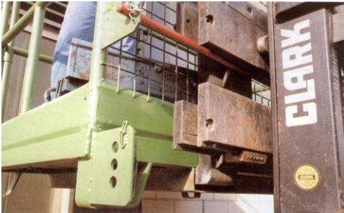
Pav. 42. Darbo platforma su apsauga nuo nušliaužimo
