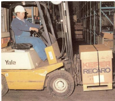
Pav. 26. Krovinį visada dėti arčiau šakių užpakalinės dalies, tada krovinio virtimo petys yra mažiausias. Prieš pradėdant važiuoti kėlimo stovą atlenkti atgal.
