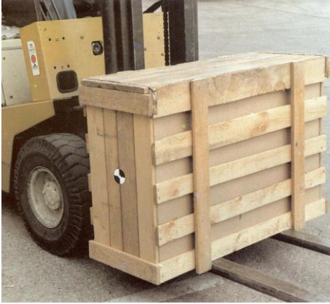
Pav. 21. Jeigu įmanoma, padėklus imti siaurąja puse, tada krovinio svorio centras visada bus arčiau šakių užpakalinės dalies.
