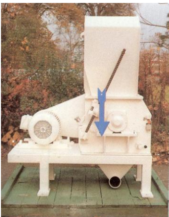
Pav. 24 ir 25. Šios smulkinimo mašinos svorio centras yra ne centre. Paprastas, tačiau aiškus ženklavimas nurodo šakinio krautuvo vairuotojui, kur turi įvažiuoti šakių peiliai, koks krovinio svoris ir kur yra jo svorio centras, būtent, strėlės (rodyklės) gale.
