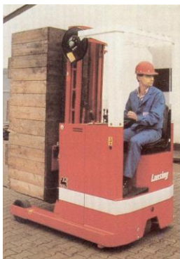
Pav. 27. Krautuvai su skersine sėdyne tinka važiavimui atbulomis.
