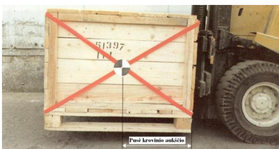
Pav. 17. Krovinio svorio centras, kaip taisyklė, yra krovinio viduryje.
