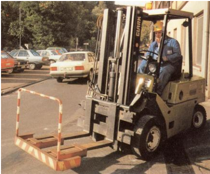
Pav. 47. Šakinį krautuvą su specialia įranga ir išspėjamaisiais dryžiais ant šakių peilių leidžiama naudoti viešajame eisme.
