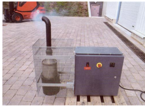
Pav.8. Suodžių filtrų regeneravimo įrenginys (filto valymas trunka apie 30 min.)
