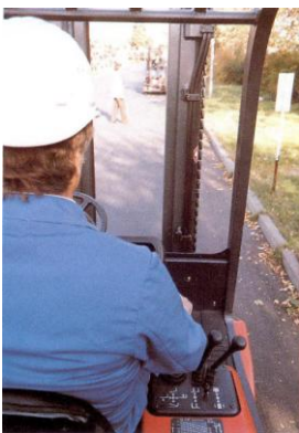
Pav.6. Optimaliai suplanuota valdymo vieta ir geresnis matomumas per laisvą tarpą kėlimo stove užtikrina darbą be nuovargio
